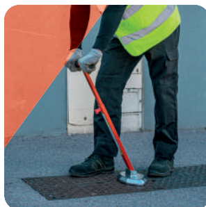
ÉTAPE 3 Pour le décrochage de l'aimant, abaisser le manche contre la butée
